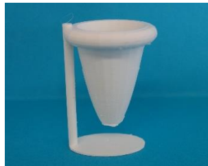
freihängender Becher, gedruckt mit unterstützenden Säulen
