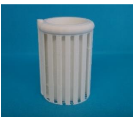
freihängender Becher, gedruckt mit unterstützenden Säulen
