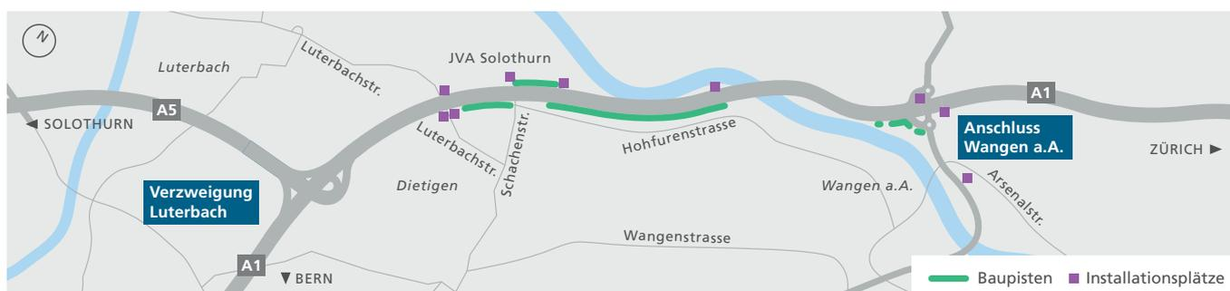
Transportpisten und Installationsplätze für das Baulos West. Der Hauptinstallationsplatz befindet sich in Wangen a.A. Auch für die späteren Baulose Mitte und Ost werden neben kleinen Installationsplätzen je ein Hauptinstallationsplatz eingerichtet. Diese liegen bei den Anschlüssen Oensingen und in Kestenholz.
